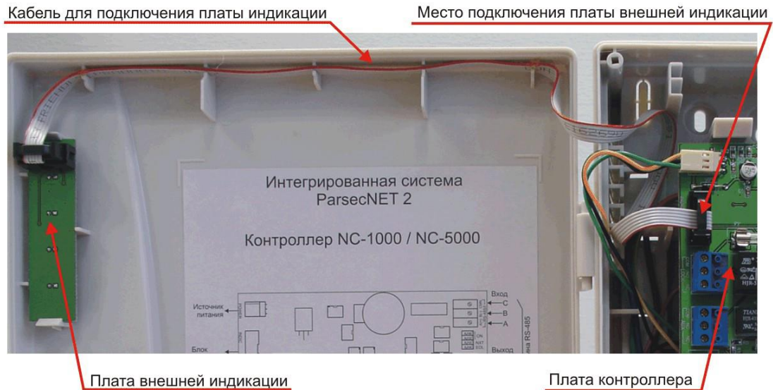
Рисунок 27. Подключение платы внешней индикации
