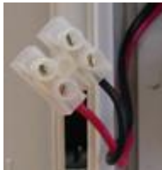
Рисунок 10. Кабель для подключения замка к блоку питания
