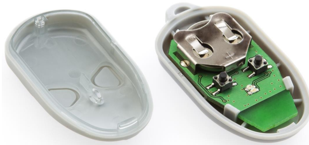
Рисунок 2. Идентификатор со снятой крышкой. Видна батарея питания
