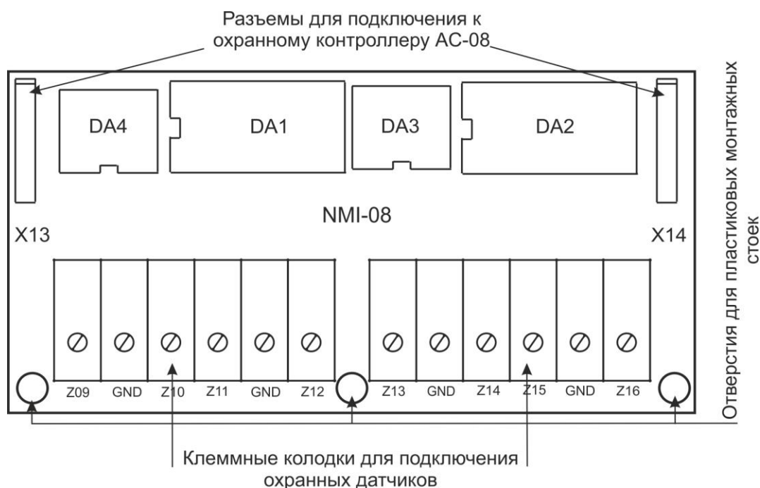
Рисунок 2. Схема платы зонного расширителя NMI-08
