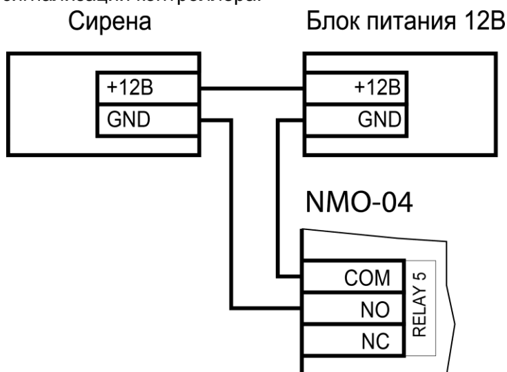
Рисунок 3. Подключение сирены к выходу реле
