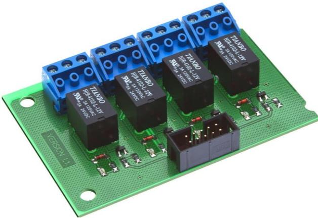
Рисунок 1. Релейный расширитель
