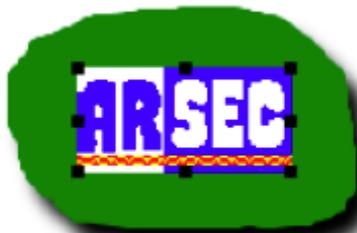
Если выбранный объект является постоянным, соответствующая кнопка в панели инструментов для работы с объектами отображается в нажатом состоянии. Если же выбранный объект – ОКНО, ЛОГОТИП, ТЕКСТ или ИНФО, то этот объект выделяется на макете прямоугольником, состоящим из восьми точек. Выделенный объект можно двигать по макету. Для этого нажмите на его поверхности левую кнопку мыши и удерживая ее в нажатом состоянии, передвиньте объект в нужное место. С помощью точек-
