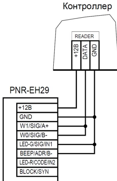
Рисунок 9. Подключение считывателя по интерфейсу Touch Memory
