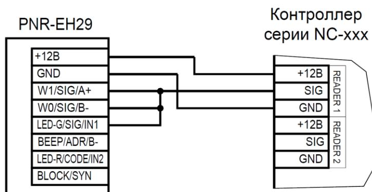
Рисунок 11. Подключение считывателя по интерфейсу Parsec, адрес 1 (внутренний)
