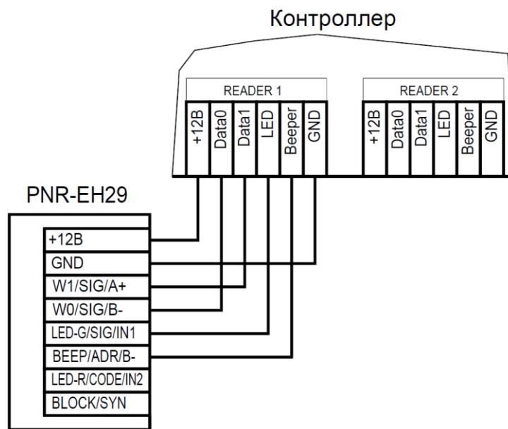
Рисунок 10. Подключение считывателя по интерфейсу Wiegand
