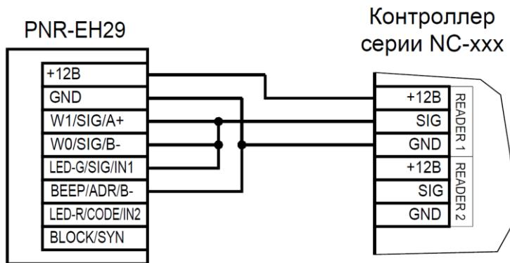
Рисунок 12. Подключение считывателя по интерфейсу Parsec, адрес 0 (наружный)
