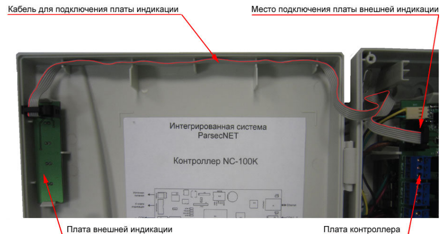
Рисунок 26. Подключение платы внешней индикации
