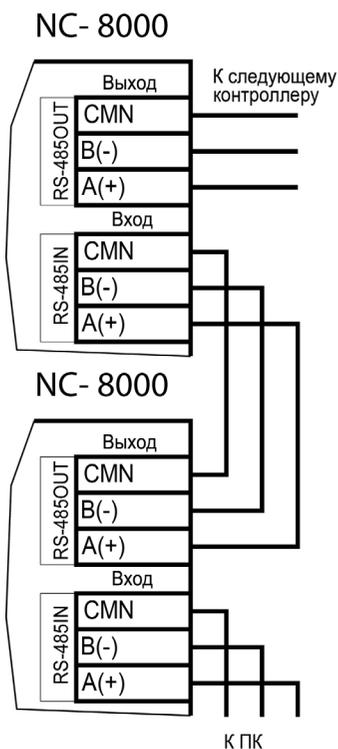
Рисунок 28. Схема соединения контроллеров по топологии «Шина»
