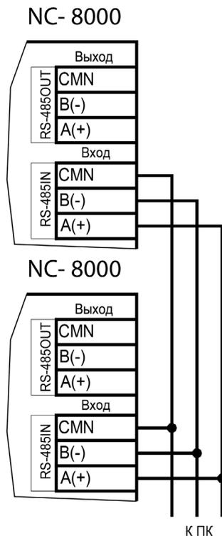
Рисунок 29. Схема соединения контроллеров по топологии «Звезда»
