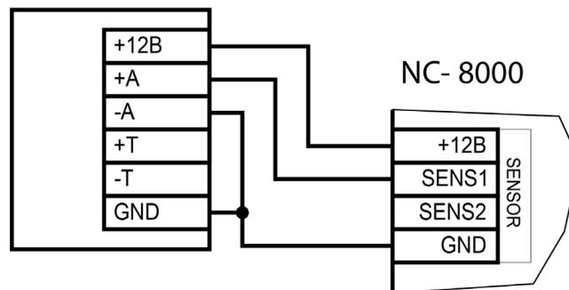
Рисунок 21. Схема подключения охранного датчика без контроля состояния линии
