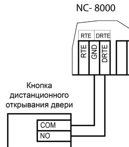
Рисунок 18. Схема подключения кнопки дистанционного открывания двери
