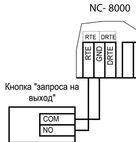
Рисунок 17. Схема подключения кнопки запроса на выход
