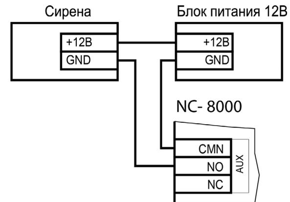
Рисунок 22. Схема подключения сирены к дополнительному реле
