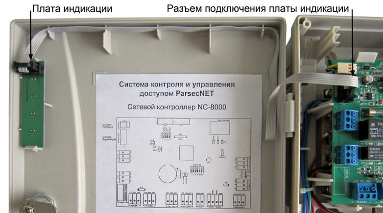
Рисунок 26. Подключение платы внешней индикации
