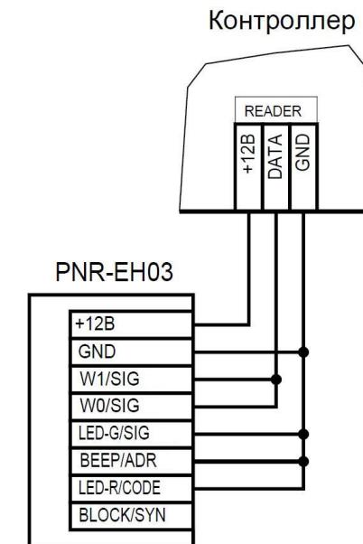
Рисунок 6. Подключение считывателя по интерфейсу Touch Memory
