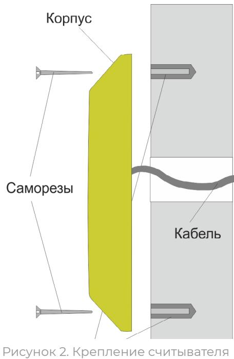
Рисунок 2. Крепление считывателя
