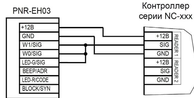
Рисунок 8. Подключение считывателя по интерфейсу Parsec, адрес 1 (внутренний)
