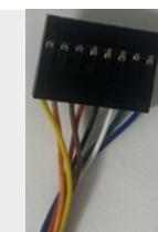
ный и белый провода (W0/SIG/B- и W1/SIG/A+) и подключите их к клемме считывателя на контроллере (рисунок 6).
