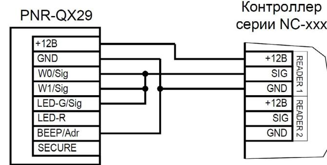
Рисунок 9. Подключение считывателя по интерфейсу Parsec, адрес 0 (наружный)
