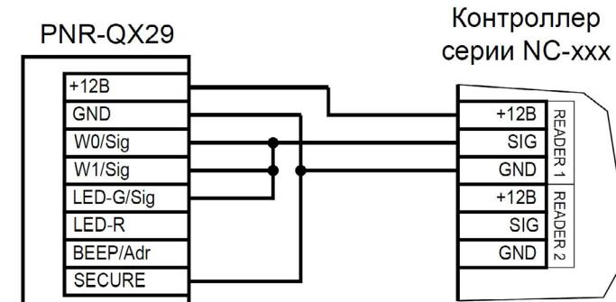
Рисунок 12. Включение защищенного режима на примере считывателя, подключенного по интерфейсу Parsec
