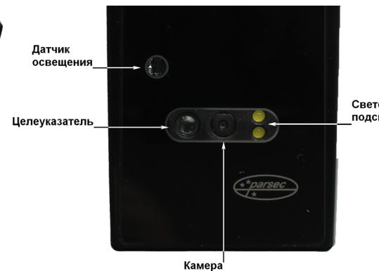
Рисунок 1. Считыватель PNR-QX29
