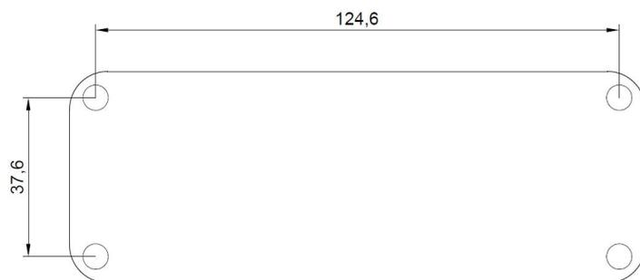
Рисунок 2. Расположение крепежных отверстий на плате считывателя
