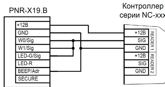
Рисунок 6. Подключение считывателя по интерфейсу Parsec, адрес 0 (наружный)
