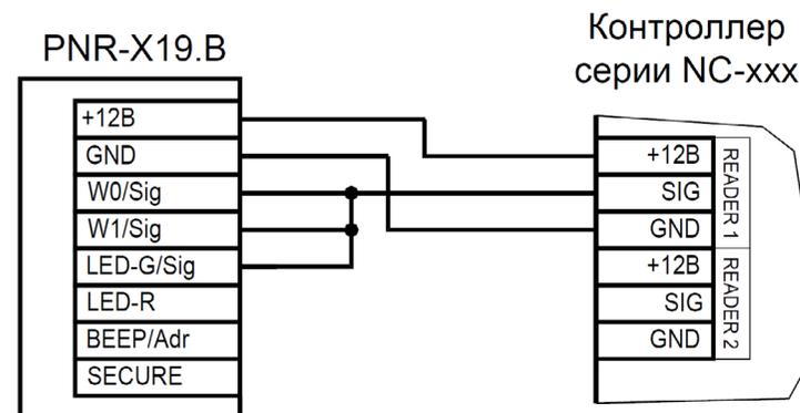
Рисунок 5. Подключение считывателя по интерфейсу Parsec, адрес 1 (внутренний)
