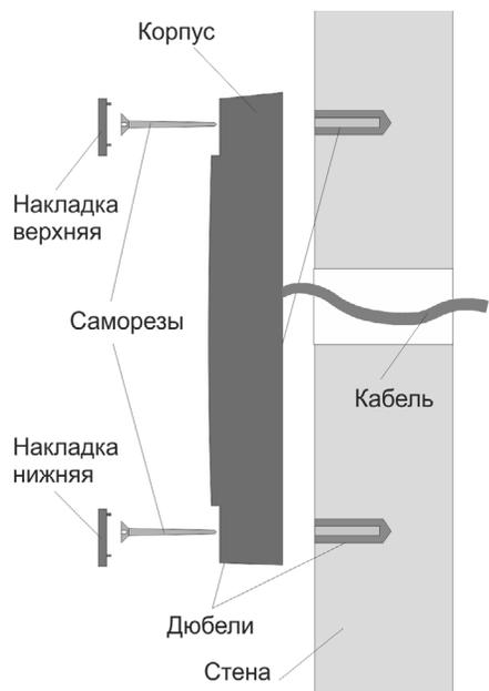
Рисунок 2. Крепление считывателя
