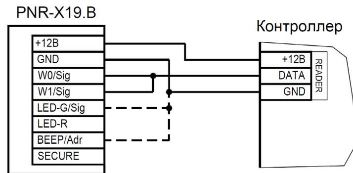
Рисунок 3. Подключение считывателя по интерфейсу Touch Memory
