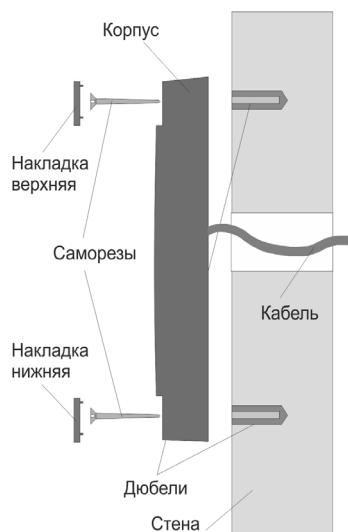
Рисунок 3. Крепление считывателя
