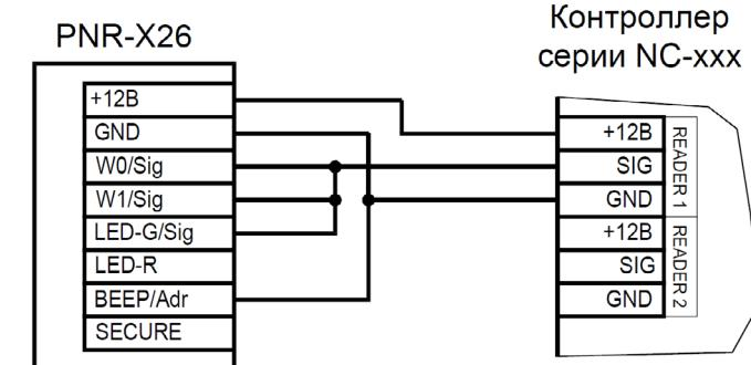
Рисунок 7. Подключение считывателя по интерфейсу Parsec, адрес 0 (наружный)
