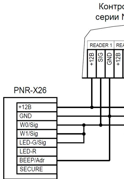
Рисунок 8. Подключение двух считывателей по интерфейсу Parsec одним кабелем
