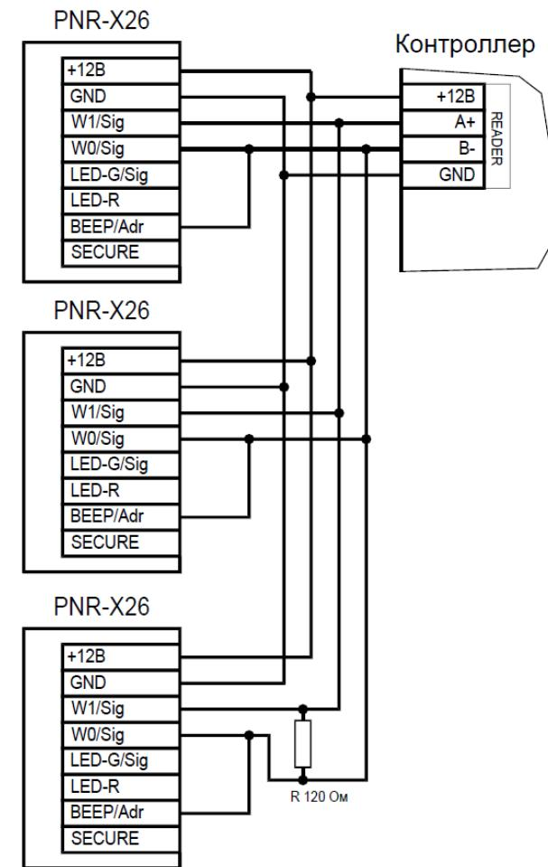
Рисунок 9. Подключение считывателей по интерфейсу OSDP
