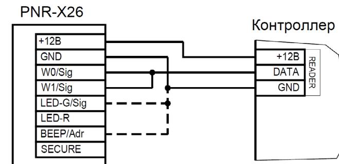
Рисунок 4. Подключение считывателя по интерфейсу Touch Memory
