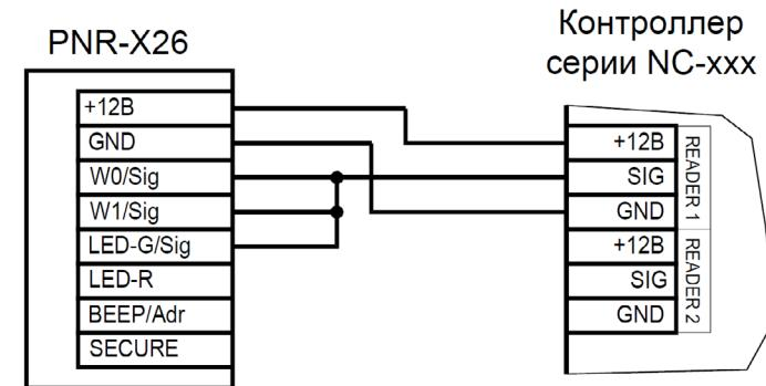
Рисунок 6. Подключение считывателя по интерфейсу Parsec, адрес 1 (внутренний)
