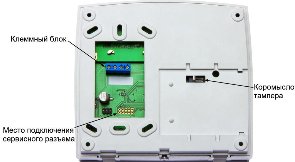
Рисунок 2. Вид клавиатуры АКД-01 сзади
