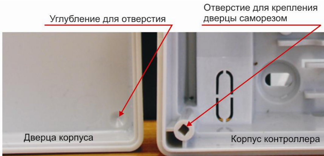
Рисунок 3. Схема «жесткого» крепления дверцы к корпусу шлюза.
