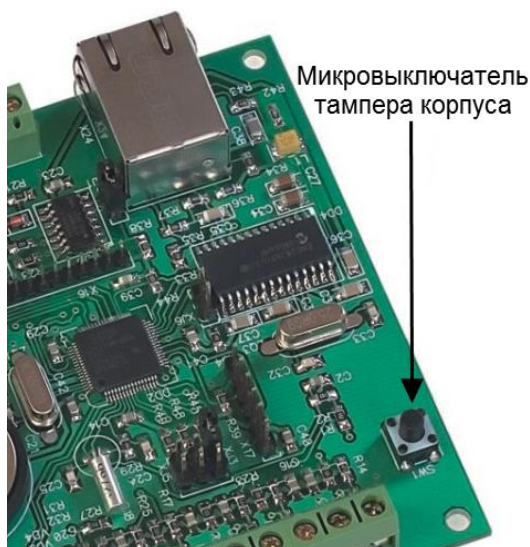
Рисунок 17. Микровыключатель тампера корпуса
