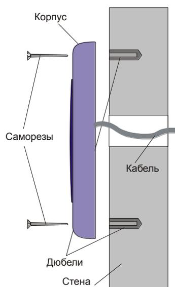
Рисунок 2. Крепление считывателя PR-A05.
