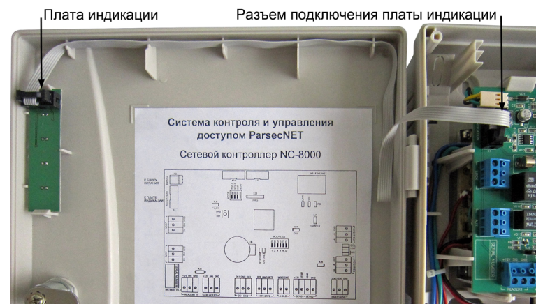
Рисунок 26. Подключение платы внешней индикации
