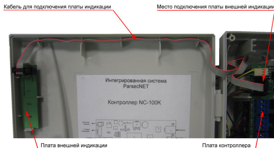
Рисунок 26. Подключение платы внешней индикации
