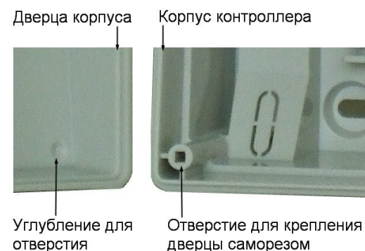
Рисунок 4. Схема «жесткого» крепления дверцы к корпусу контроллера
